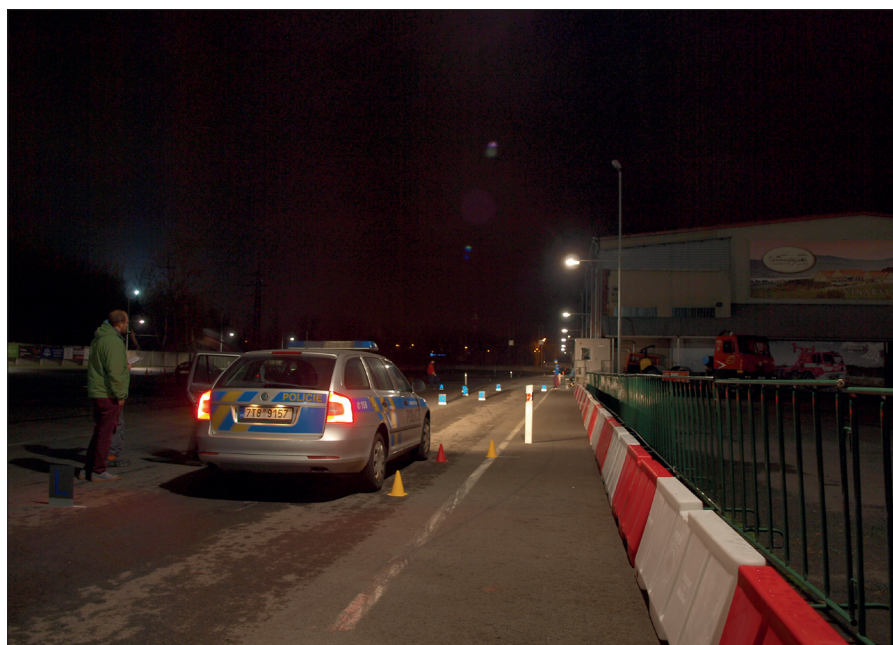
Obr. 9. Poloha vozidla na fiktivní noční osvětlené komunikaci s neosvětleným přechodem pro chodce při jasové analýze viditelnosti chodců v nástupním prostoru
